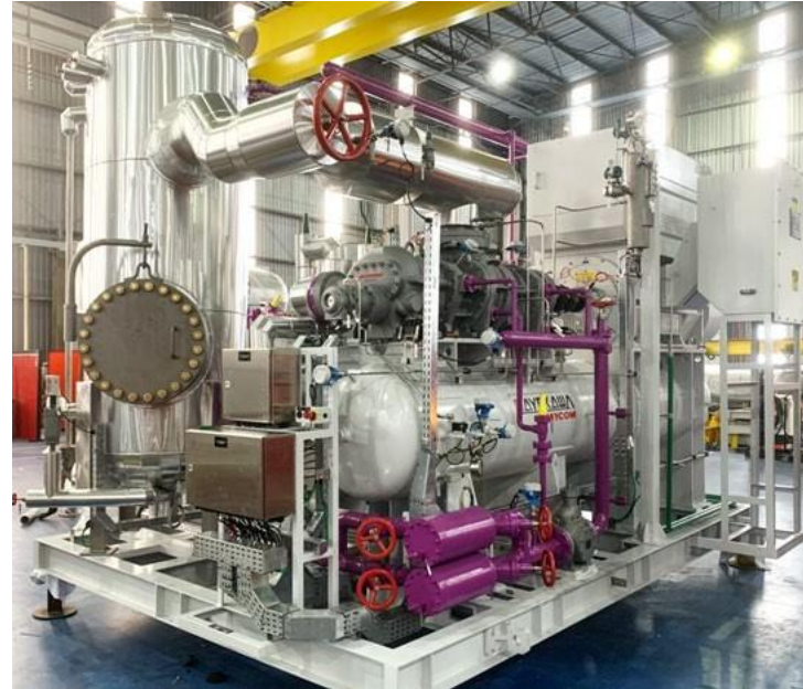
Unidad BOG Para relicuación de NH 3 en el proceso
