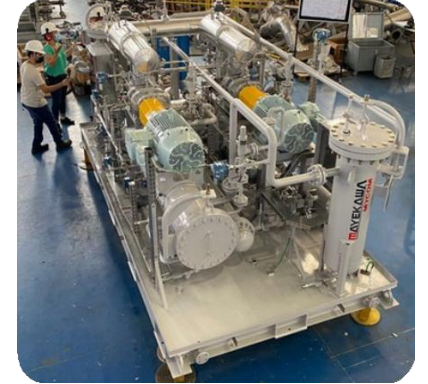
Ejemplo de un sistema de relicuación para almacenamiento (FGSS)
