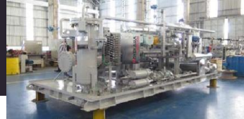
LNG BOG Compressor - Brazil 200C / 1400kW
